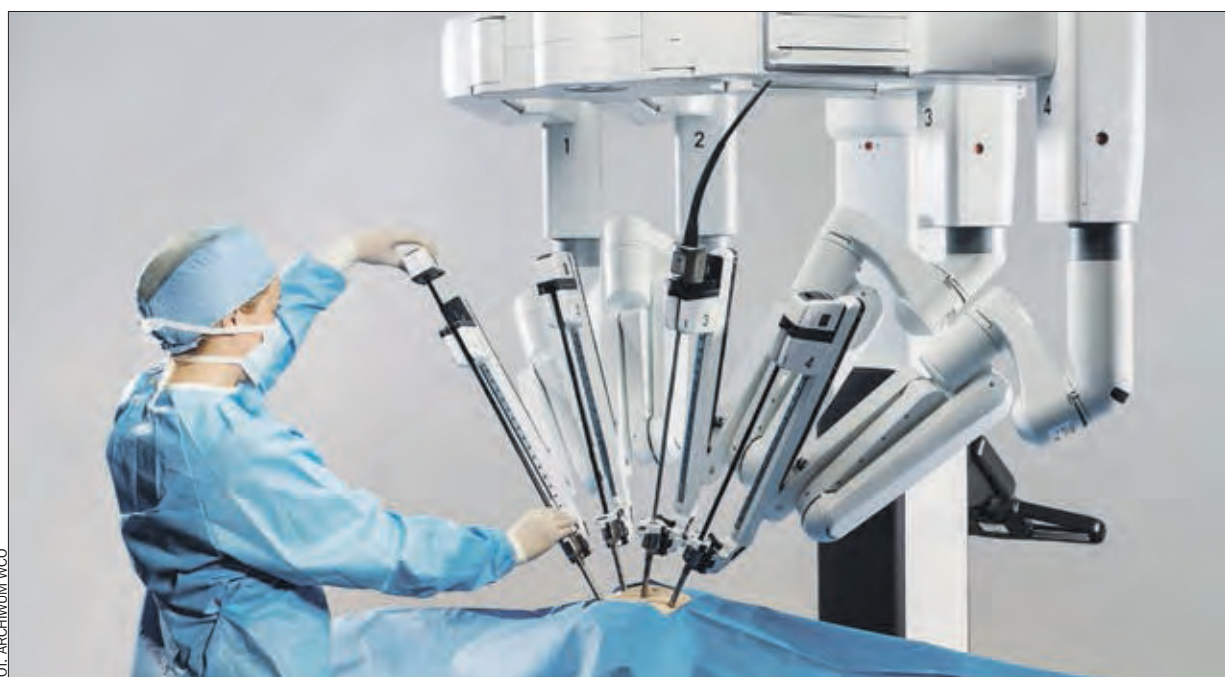
Urządzenie posiada cztery „ręce”, a jedno ramię jest zakończone kamerą endoskopową.
