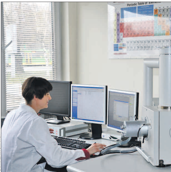
FOT. ARCHIWUM INOP Justyna Wendland – doktorantka INOP, podczas wykonywania badań za pomocą mikroskopu SEM wyposażonego w EDS i EBSD.
