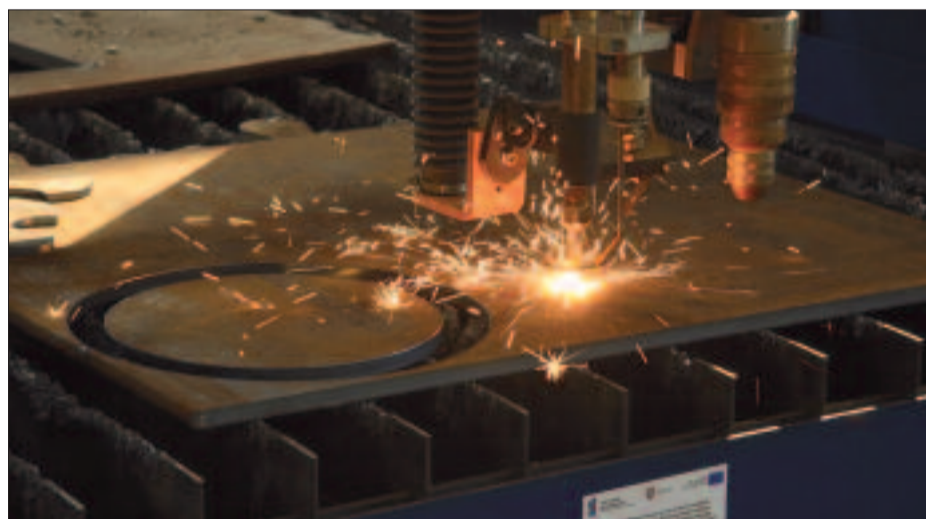
Przecinarka plazmowo-gazowa tnie metal z dużą precyzją.
