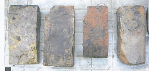
Cegły z żabikowskiej cegielni o wymiarach 14x30x7(6) cm wydobyte w październiku 2006 r. podczas rozbierania mostka na Strumieniu Junikowskim. Dla porównania w środku cegła współczesna (mniejsza 12x25x6 cm) fot. Piotr P. Ruszkowski
