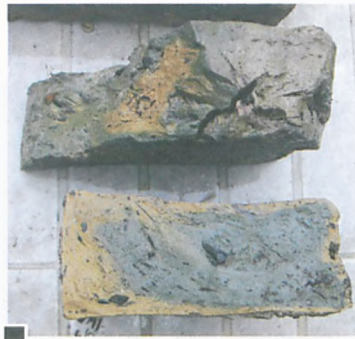
Charakterystyczny dla żabikowskiej cegły przekrój, w którym mieszają się kolor żółtej gliny z szarą fot. Piotr P. Ruszkowski
