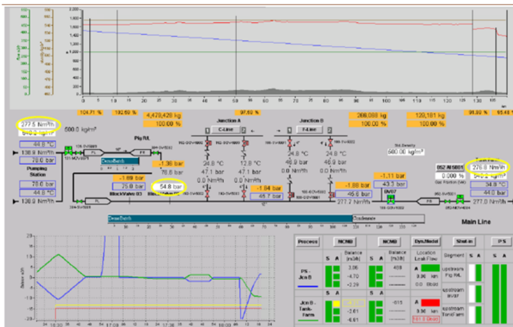
Rysunek 2.14: Kontrola parametrów pracy systemu rurociągowego w systemie SCADA.
