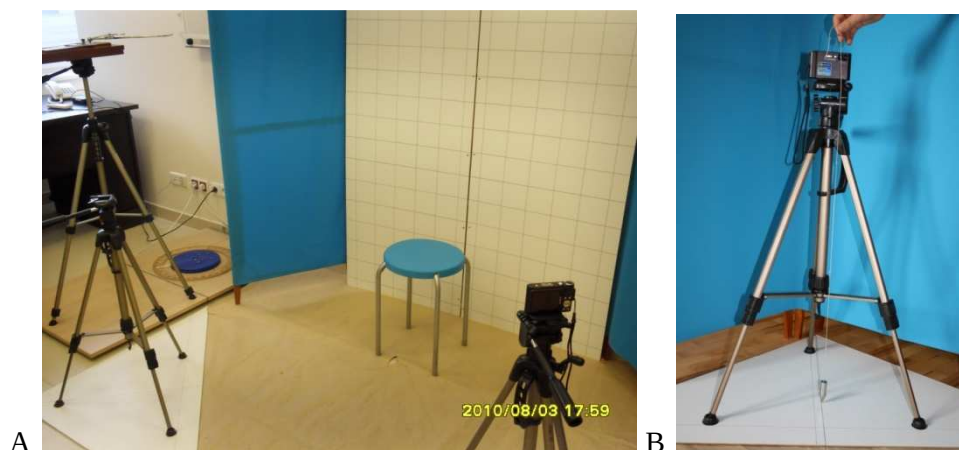
Rycina 4.7. Stanowisko własnego pomysłu do wykonywania fotografii skośnych tułowia. A. widok ogólny, B. sposób ustawienia podstaw aparatów fotograficznych.
