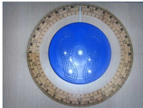
Rycina 4.5. Fragment stanowiska do pomiaru długości osi klatki piersiowej: podstawa - twister z zamontowanym kątomierzem.
