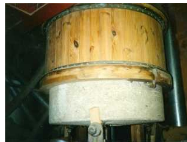
Fot 7. Urządzenie służące do odplewiania ziarna orkiszu – łuszczarka (Biohof – lex..., 2008).
