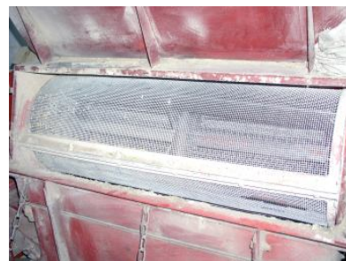
Fot 5. Sita stalowe w bukowniku dostosowanym do odplewiania ziarna orkiszu (Tyburski, Babalski, 2006).
