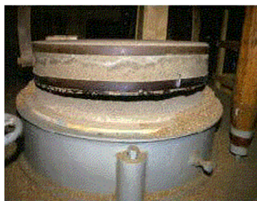
Fot 6. Urządzenie służące do odplewiania ziarna orkiszu – łuszczarka (Kling 2005, University of Hohenheim, Stuttgart, Germany).
