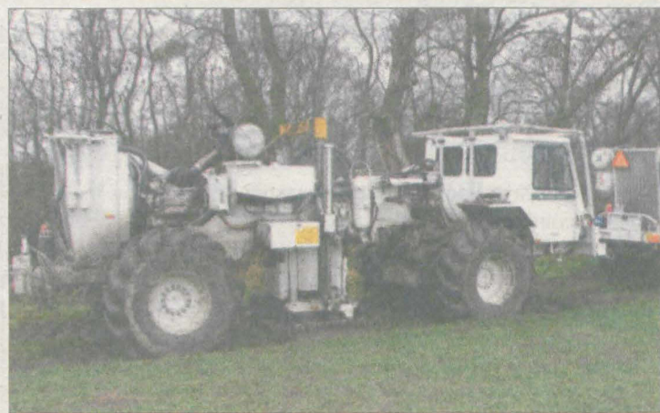
Drżania wywołują 20-tonowe wibratory, które poruszają się w zespole składającym się z czterech takich pojazdów.
