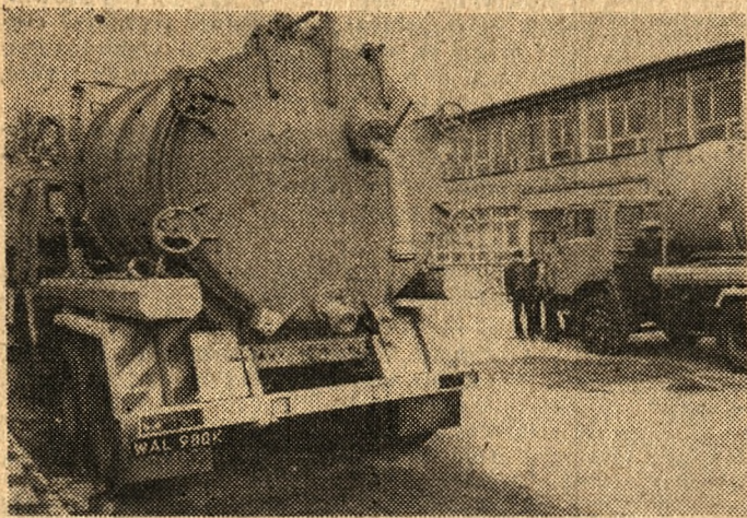
Zakłady „Presko” we Wschowie (województwo leszczyńskie) produkują urządzenia dla gospodarki komunalnej. Od niedawna zakład montuje nowego typu wozy asenizacyjne (o pojemności 10,5 m. sześć.) na podwoziu samochodu „Kamaz”. Na zdjęciu: wozy przeznaczone dla Warszawy.
