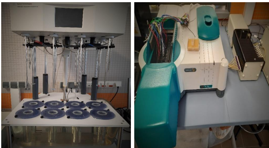
Ryc.7. Aparat dyfuzyjny 708-DS wraz z spektrofotometrem UV-Vis.
