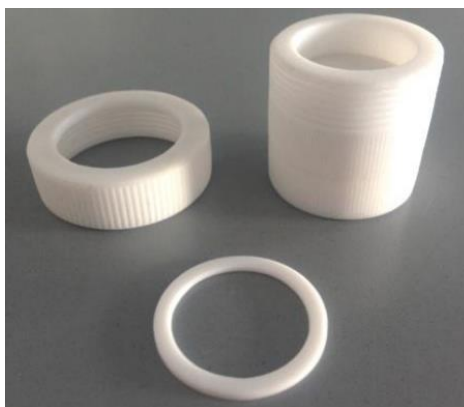
Ryc. 8. Teflonowe komory ekstrakcyjne przed nałożeniem hydrożelu z SLN inkorporowanego EGCG.
