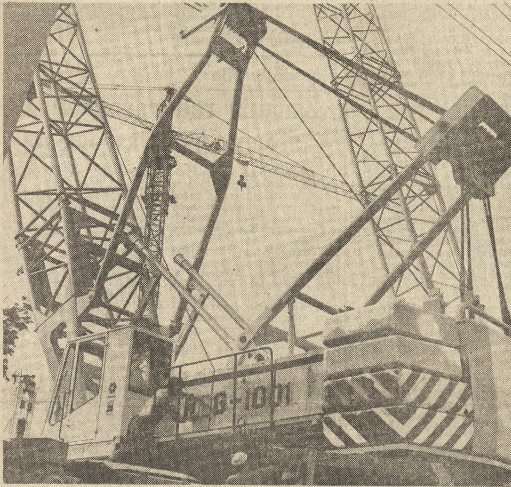
Samobieżny dźwig typu HDG-1001, wyprodukowany w Zakładach Doświadczalnych „Bumar-Budor” w Kobyłce koło Warszawy, to jedna z wielu atrakcyjnych na 49 MTP propozycji polskiego przemysłu dla potrzeb budownictwa. Widoczne na zdjęciu urządzenia, które zapewne wzbudzi zainteresowanie fachowców, waży 100 ton, a podnosić może ciężar do 140 ton na wysokość 45 metrów.
