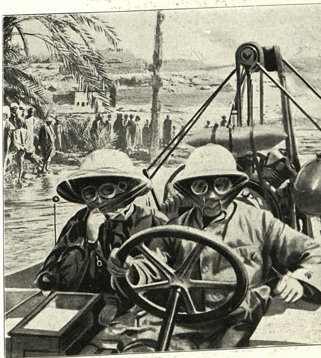
J. Schneider przebył drogę Nilem z Kairu do Chartumu, osiągając szybkość 50 kilom. na godzinę w łodzi motorowej własnego wynalazku o śrubie powietrznej na wzór śrub u aeroplanów.
