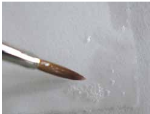
Fot. 2. Tworzenie się pęcherzyków powietrza na podłożu papierowym w procesie przygotowywania papieru albuminowego
