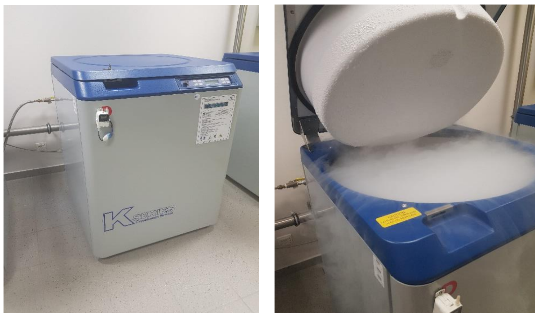
Rycina 16. Zbiorniki magazynowe zasilane w ciekły azot (zdjęcie własne)
