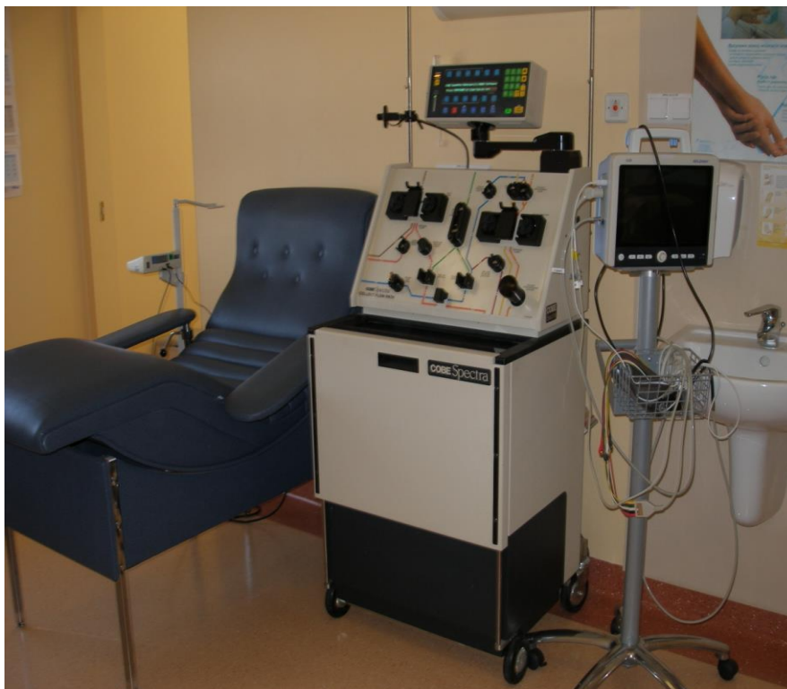
Rycina 5. Separator komórkowy- Cobe Spectra (zdjęcie własne)
