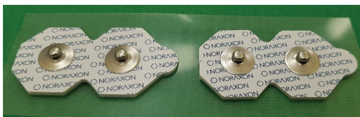
Rycina 13. Rycina przedstawia fotografię elektrod jednorazowych, samoprzylepne chlorkowo-srebrowe (AgCl) do EMG TYCO/Kendall typ H124SG (symbol 31.1245.21 ECG EL PRST FOAM) o średnicy średnica 24 mm. Źródło: zbiory własne
