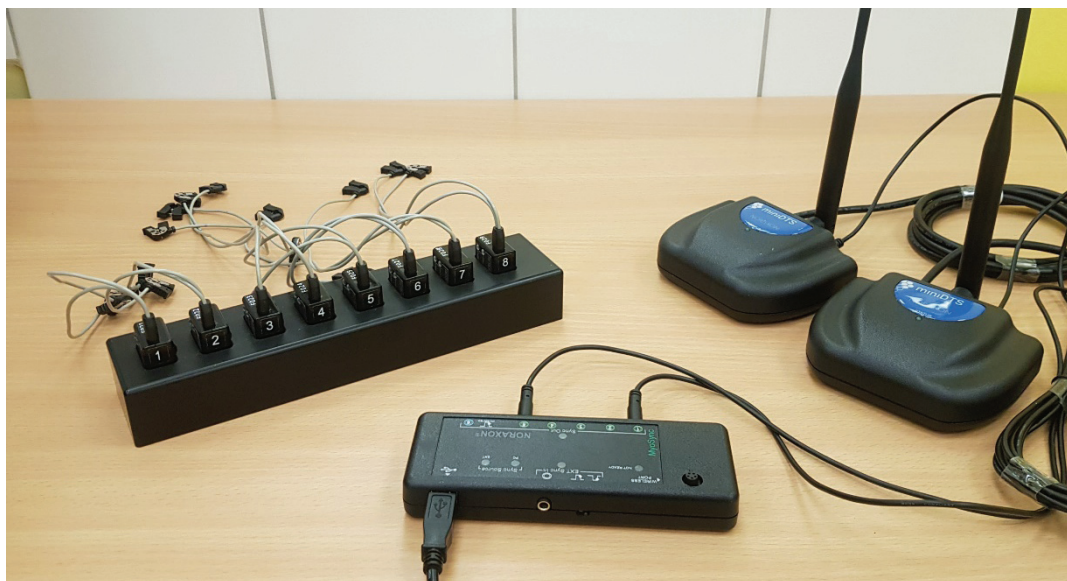
Rycina 11. Rycina przedstawia fotografię urządzenia Noraxon Mini DTS 8 K MR 3 myoMuscle Master Edition, USA. Od lewej: zestaw czujników bezprzewodowych w stacji ładującej, MyoSync® – urządzenie do synchronizacji sygnału bezprzewodowego, MiniDTS® – dwa odbiorniki sygnału bezprzewodowego. Źródło: zbiory własne
