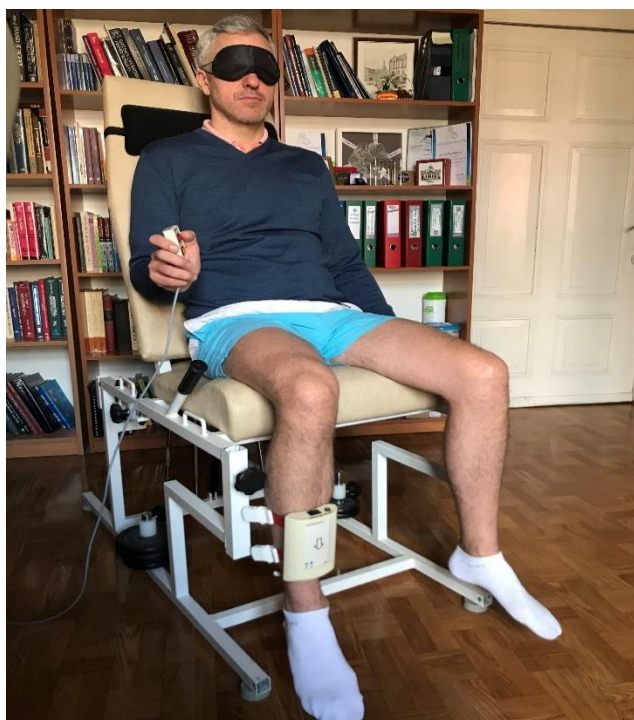
Ryc. 34 Pozycja badanego na fotelu i mocowanie Propriometru (materiał własny)
