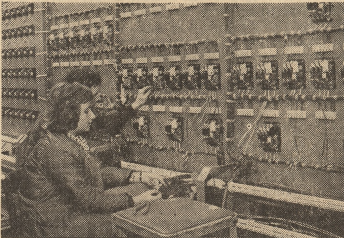
Montaż tablic rozdzielczych na wydziale budowy szaf i pulpitów. Fot. — M. Pankowiak
