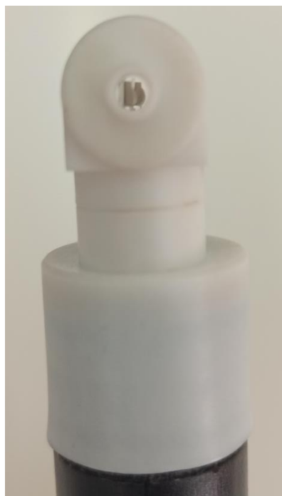
Ryc. 4. Tewametr® z nałożoną końcówką adaptującą.
