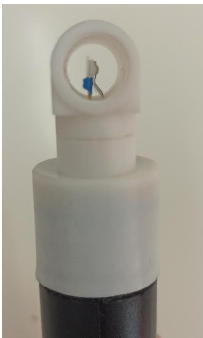
Ryc. 3. Tewametr® przed nałożeniem końcówki adaptującej.
