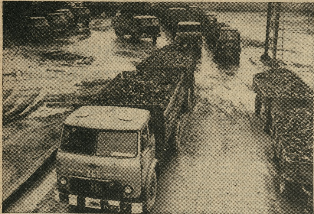
Widok na plac składowy cukrowi. W głębi widoczne przemyśle buraków. Kolejka przed punktem hydrowyładowczym tylko pozorna, gdyż strumień wody z aparatu zmywa surowiec z przyczepy w ciągu jednej minuty.
