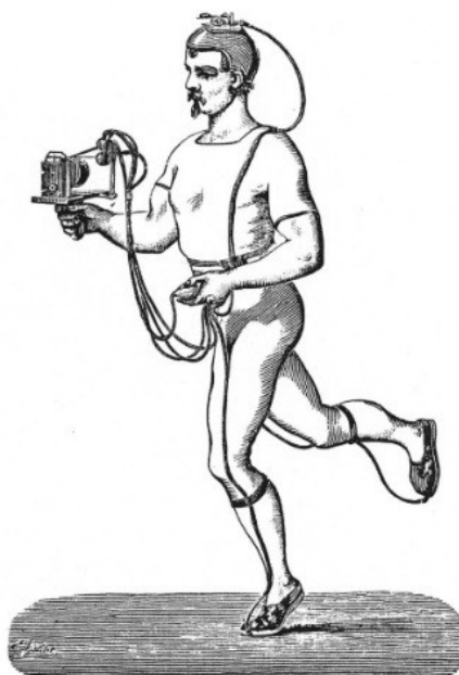
Rycina 1. Praca Etienne-Julesa i ryciny eksperymentalnych urządzeń do rejestracji ruchu i oceny nacisku
