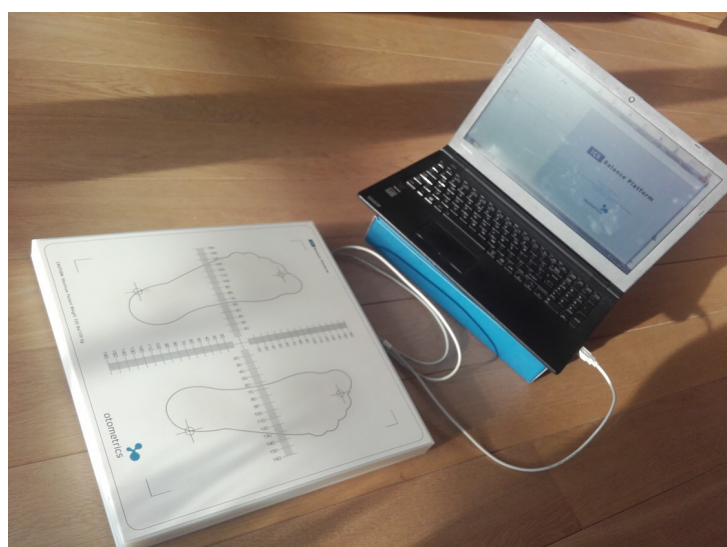
Rycina 21. Zestaw do walidacji ICS (komunikacja przewodowa przez port USB)
