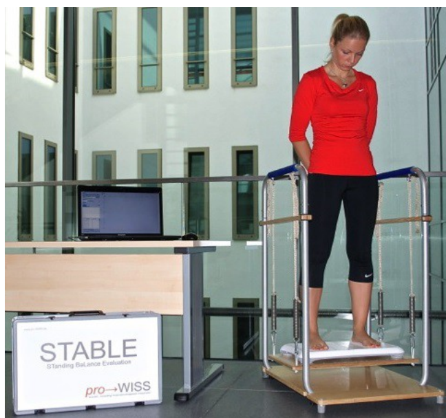
Rycina 9. Adaptacja statycznej platformy posturograficznej do badań dynamicznych (źródło: www.pro-wiss.de )
