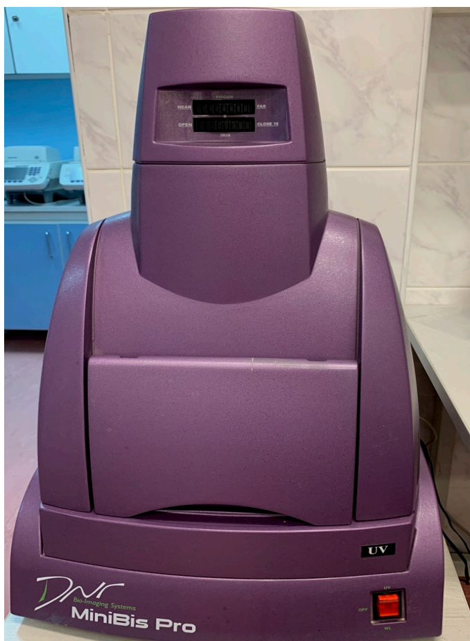
Rycina 3.5.3. System MiniBis Pro do analizy migracji produktów elektroforezy pod lampą UV (DNR)
