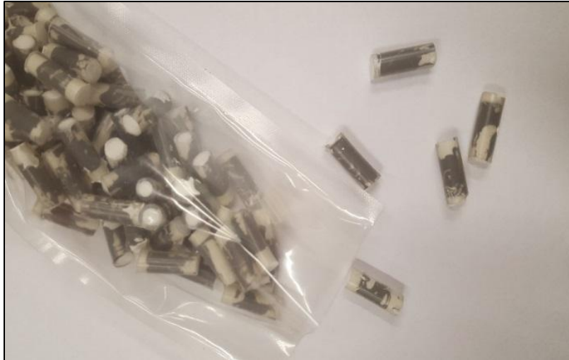
Rys. 22 Pochłaniacz tlenu ZEVIFOS w formie kapsułek żelowych przygotowany do umieszczenia w opakowaniach z kawą mieloną paloną [Źródło: zdjęcie własne]
