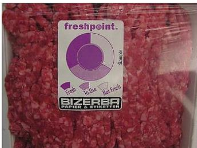
Rys. 16 System indykatorowy temperatury dla łatwo psujących się produktów oferowanych przez firmę FreshPoint Quality Assurance Ltd. [N24]
