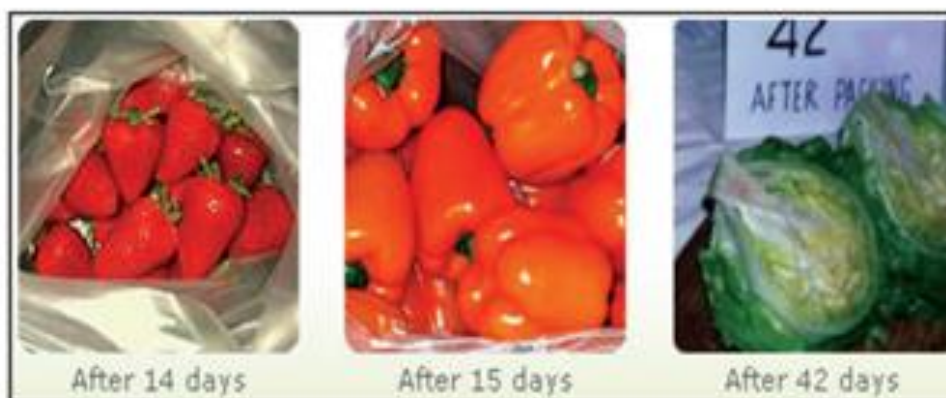
Rys. 1 Folia PEAKfresh® z wkomponowanym w nią pochłaniaczem etylenu wydłużająca trwałość owoców i warzyw [N18]
