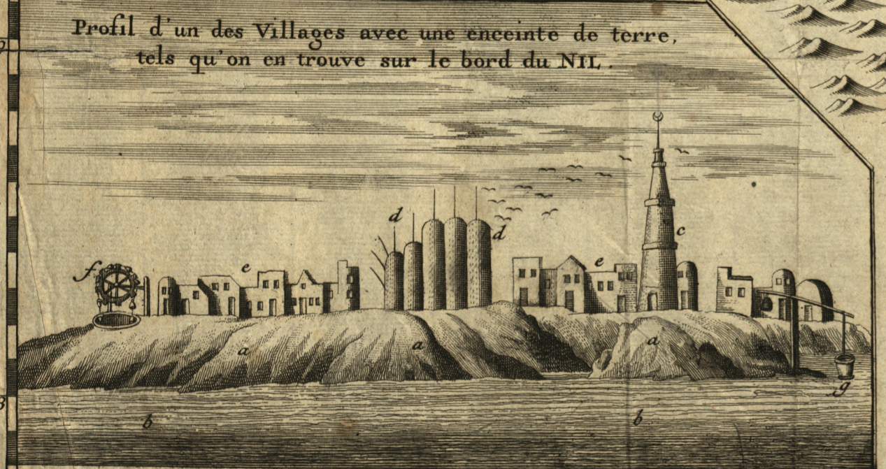
a a a. Les Bords du Nil. b b. Le Nil. c. Mosquée. d d. Colombier. e e. Les Maisons près de la Riviere. f. Roué Persanne, placee sur un Puits creuse un peu plus bas que le niveau du Nil, pour y faire venir l'eau. g. Autre Machine en guise de levier pour puiser de l'eau.
