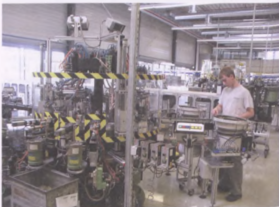
Wysokiej wydajności automat montażowy obsługuje jeden pracownik na zmianie
