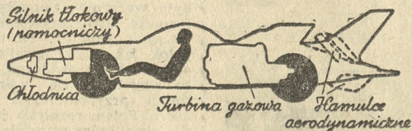
Przekrój podłużny samochodu Firebird, uwidoczniający rozmieszczenie najważniejszych agregatów.
