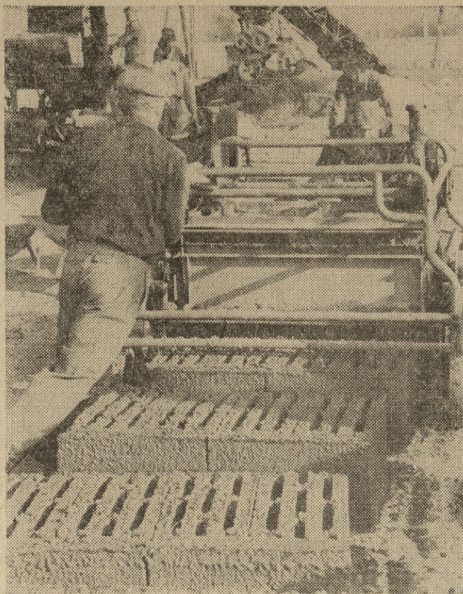
Gdy wszystko „gra”, można wyprodukować w ciągu jednej zmiany do 700 pustaków, czyli domek w ciągu trzech dni.
