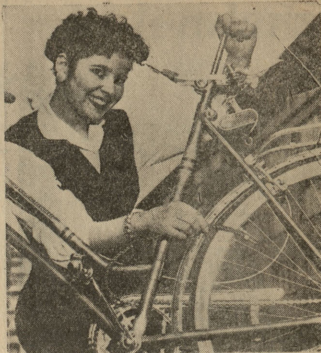
Dla zapominalskich jedna ze firm frankfurckich wyprodukowała rower z „wbudowaną” pompką powietrzną. Uchwyt pompki ukryty jest pod odchylanym siodełkiem. Część ramy roweru służy jako osłona pompki. Fot. — CAF
