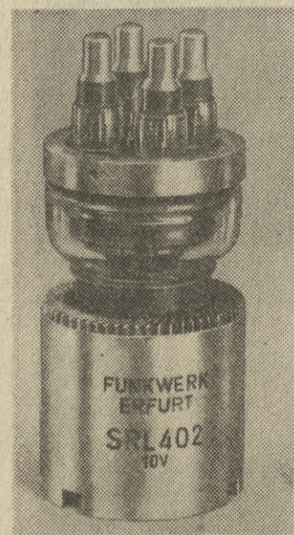
Tetrad nadawcza SRL 402 dla odbiorników telewizyjnych oraz na zakresy fal ultrakrótkich.
