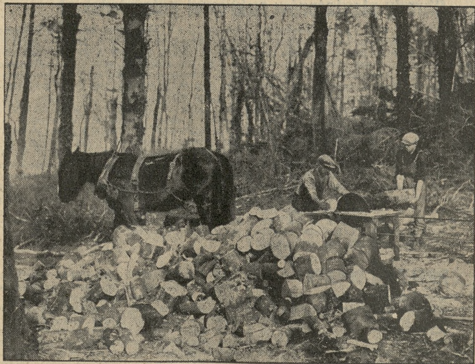
W konserwatywnej Anglii hołduje się jeszcze modzie kominków. W kominkach angielskich więc dużo się spala drzewa, które dla tem szybszej „produkcji” i dla wygody odbiorców ciwartuje się już w lasach przy pomocy udoskonalonej pily z elektrycznym zapędem, jak to widzimy na powyższym zdjęciu.
