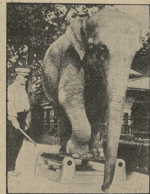
Słoń wyrosnięty na szklanej płycie. Pewnemu technikowi amerykańskiemu udało się wynaleźć sposób hartowania szkła, wytrzymałego na napór nawet takiego ciężaru, jak kilkotonowy słoń.
