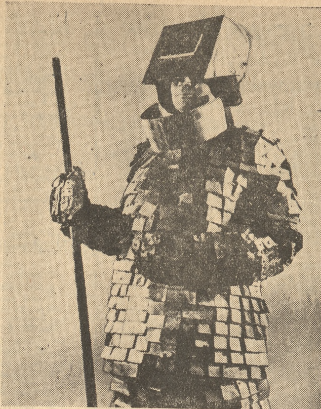
Fot — CAF Pracownicy Instytutu Ochrony Pracy w Leningradzie opracowali model metalowego ubrania ochronnego. Ubranie to stosowane będzie przez robotników niektórych działów w hutach i fabrykach obróbki metali. Waży ono zaledwie 3,6 kg.
