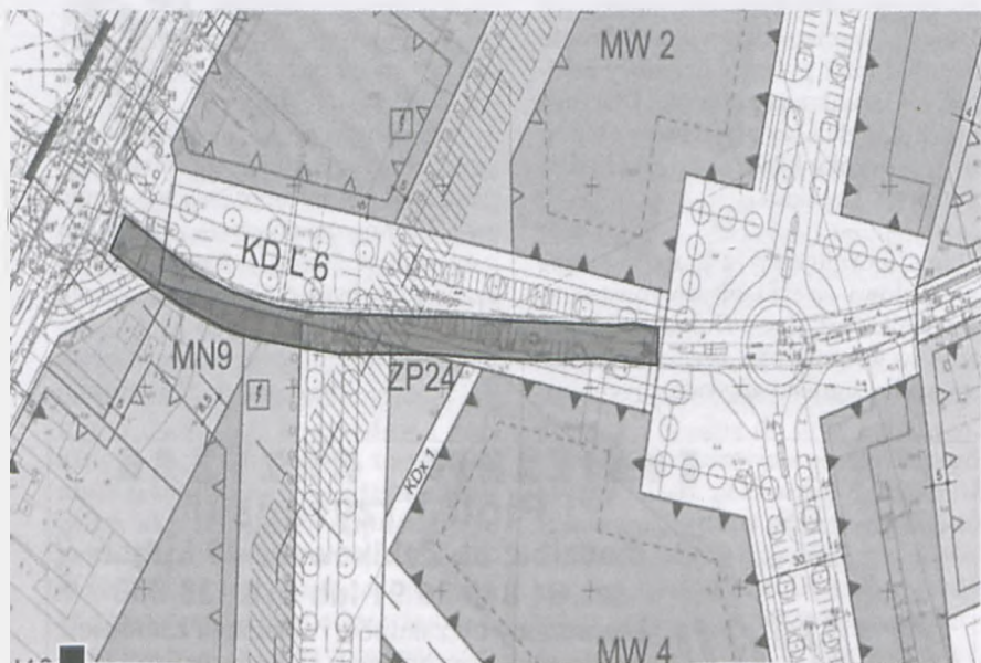
Na wycinku „Miejscowego planu zagospodarowania przestrzennego Luboń-Centrum” ciemnoszarym kolorem zaznaczono istniejącą ul. Pułaskiego, która, jak widać jest przesunięta na południe w stosunku do planowanego pasa drogi (KDL 6). Teren, na którym powstał dziki parking, znajduje się po północnej stronie ciemnoszarego pasa, w przyszłym przebiegu ulicy
