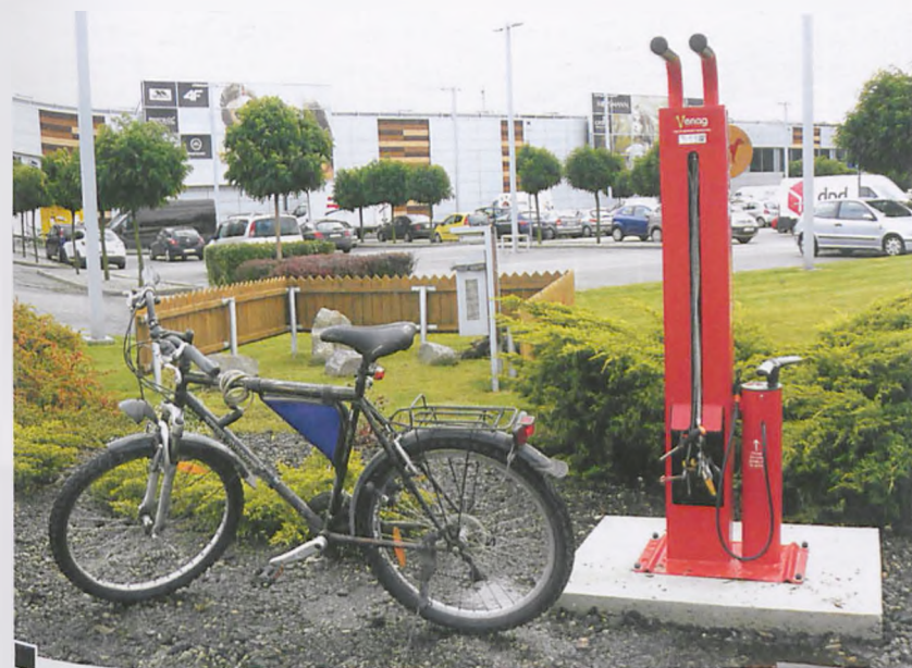
Nowa, samoobsługowa stacja naprawy rowerów wyposażona jest w: pompę przystosowaną do wszystkich rodzajów wentyli, manometr, wkrętaki, klucze rowerowe, także imbusowe oraz łyżki do opon eliminujące ryzyko uszkodzenia obręczy kół. Warto podkreślić, że specjalna konstrukcja chroni narzędzia przed działaniem czynników atmosferycznych fot. Paweł Wolniewicz
