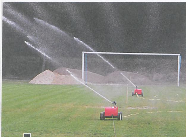
Dwie samobieżne (przeciągane linką) polewaczki (tzw. „pieski”), które od lipca są na wyposażeniu stadionu, prawie codziennie, w pięknym słońcu dni podlewają murawę boiska. Zasięg podlewania zależy od ciśnienia wody i może mieć maksymalnie do 30 m. Urządzenia te kosztowały po 7 380 zł (brutto). i były też zakupione przez Urząd Miasta fot. Piotr P. Ruszkowski
