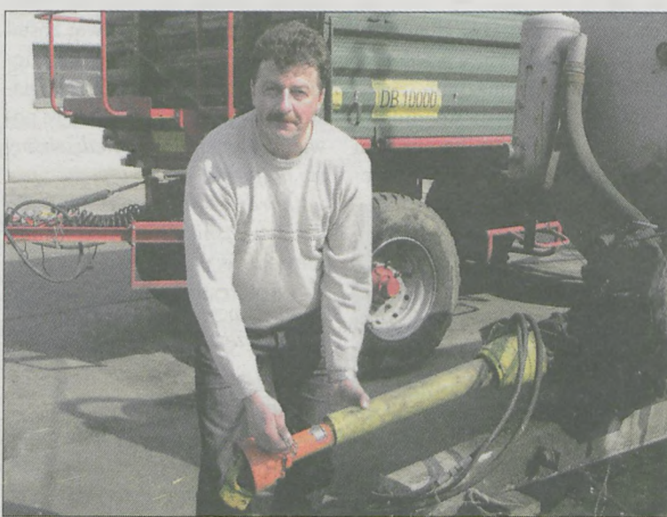
- ZALEŻY MI NA WŁASNYM ZDROWIU, dlatego staram się, żeby prace wykonywane były w bezpieczny sposób. Pamiętam m.in. o używaniu osłon do wałków przekładników mocy - podkreśla Marek Kardach
