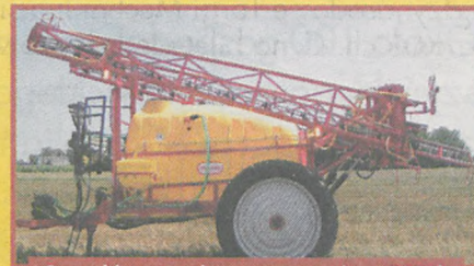
Opryskiwacz połowy przyczepiany 3000l, zbiornik włoski, belka 24 m hydraulicznie rozkładana
