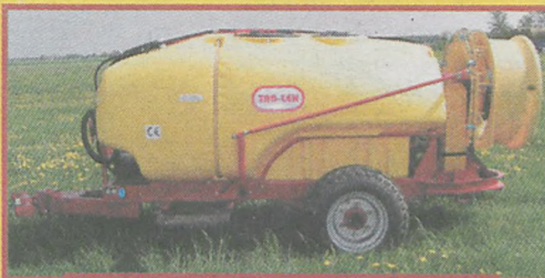
Opryskiwacz sadowniczy 2000 l, zbiornik włoski, przystawka tradycyjna
