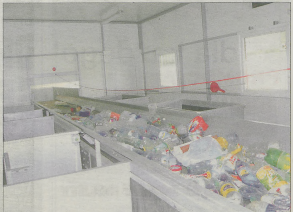
Linia do segregacji śmieci w nowo wybudowanej sortowni w Zakładzie Gospodarki Odpadami w Witaszyczkach
