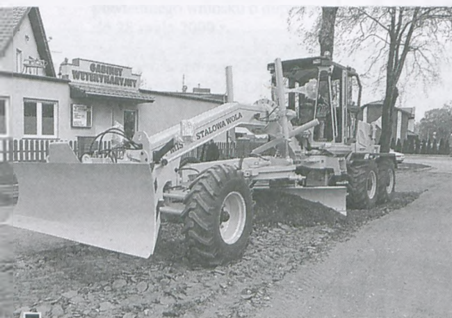
Nowy model wyrówniarki ze Stalowej Woli z funkcją spulchniania zewnętrznej warstwy przed wyrównaniem podczas pokazu i prezentacji na ul. Poznańskiej fot. Piotr P. Ruskowski
