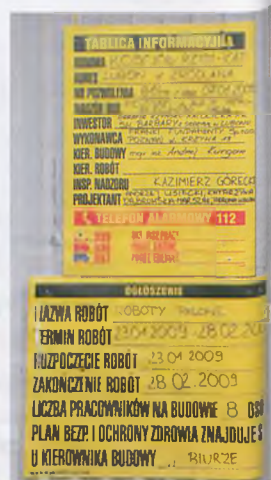
Plac budowy został dobrze przygotowany o czym świadczą: właściwe ogrodzenie terenu oraz wzorowo wypełnione tablice informacyjne fot. Hanna Siatka
