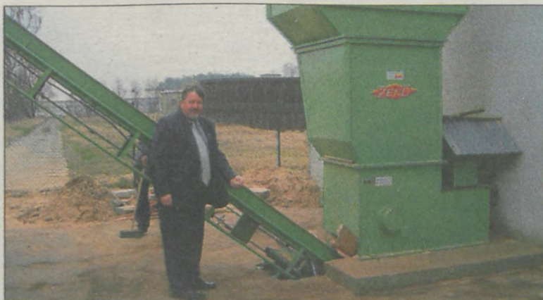
KILKA MASZYN związanych z nowym kierunkiem produkcji pracuje już w Goli. Między innymi rembak, który rozdrabnia odpady poprodukcyjne. Urządzenie prezentuje Stanisław Osiewicz.
