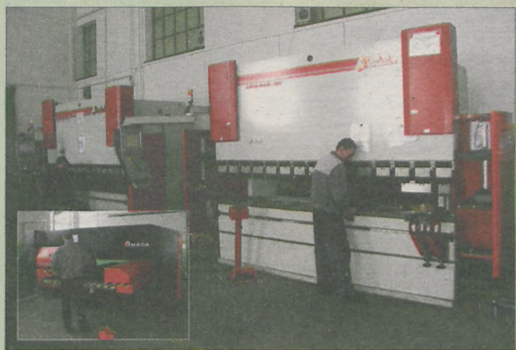
Do zaginania blach wykorzystywane są najnowsze zaginarki krawędziowe oraz prasy rewolwerowe
