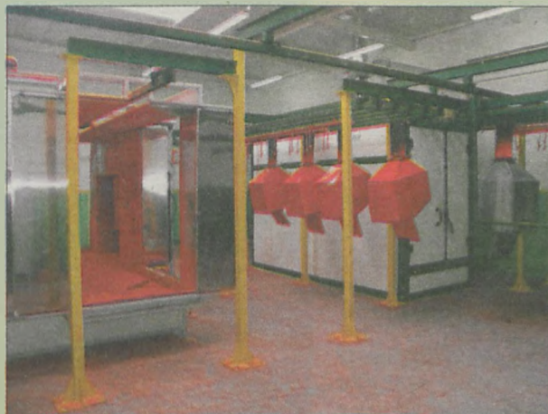
Elementy kotłów malowane są w nowoczesnej lakierni proszkowej
