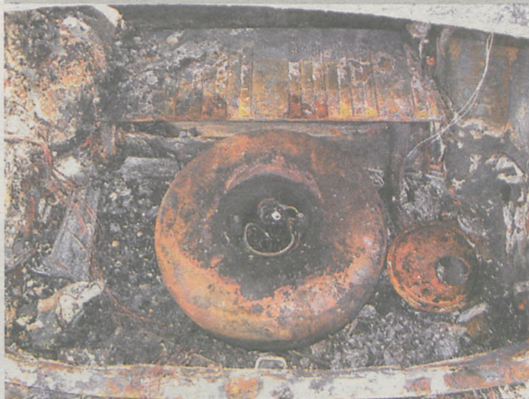
O trwałości i bezpieczeństwie instalacji gazowej świadczy to zdarzenie. Auto spaliło się doszczętnie, a butla na gaz została
