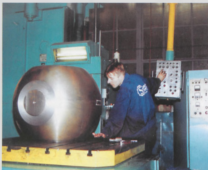
„Serce” zaworu kulowego podczas obróbki na wytaczarce. Maszynę obsługuje Robert Witkowski.
