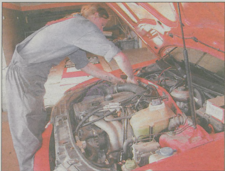
Marcin Kościuk podczas montażu instalacji gazowej
