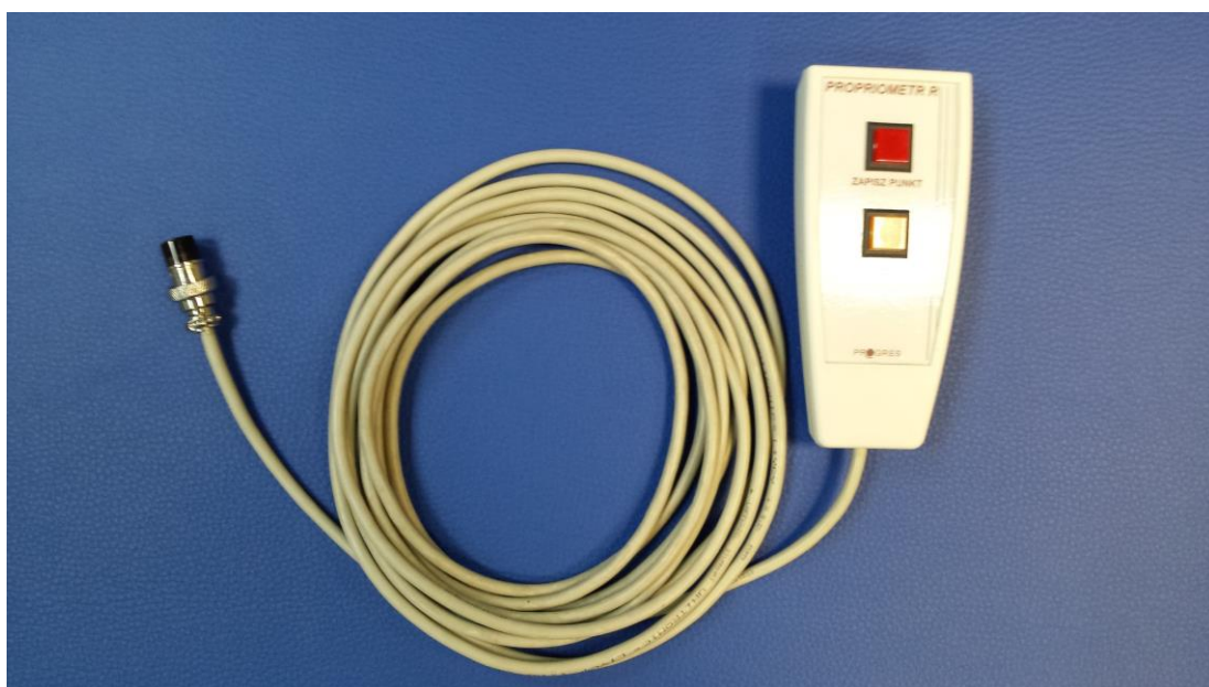
Rycina 15. Pilot – urządzenie do zatwierdzania pozycji stawu (materiał własny).
