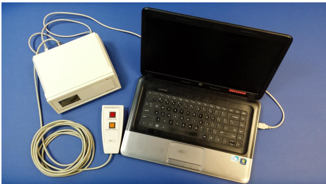
Rycina 17. Połączenie jednostki centralnej PROPRIOMETRU z komputerem (materiał własny).
