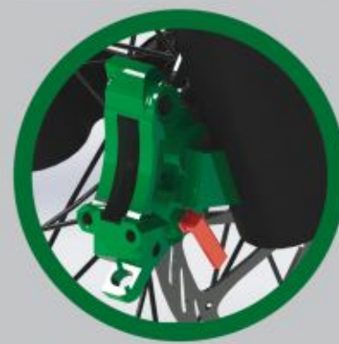
PRZEDNI ZACISK HAMULCOWY Z CZUJNIKIEM OBROTU
