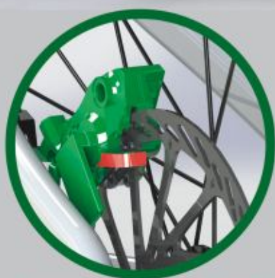
TYLNY ZACISK HAMULCOWY Z CZUJNIKIEM OBROTU
