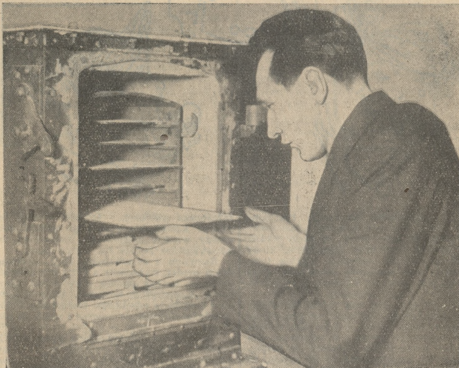
Wyjmowanie z pieca szybki witrażowych po wypaleniu.
