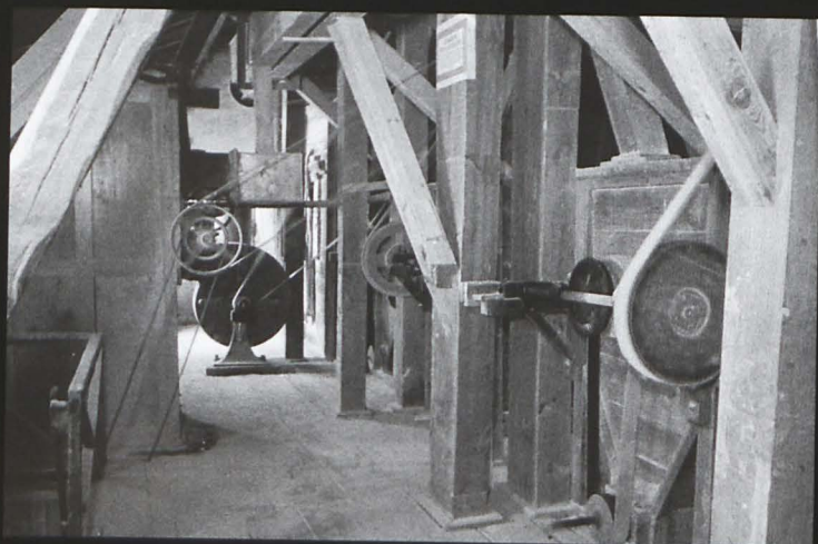
Tuliszaków - 20 sierpnia 1942 r. Wnętrze młyna miejskiego. Na fotografii dobrze widoczne pasy przenoszące napęd.
