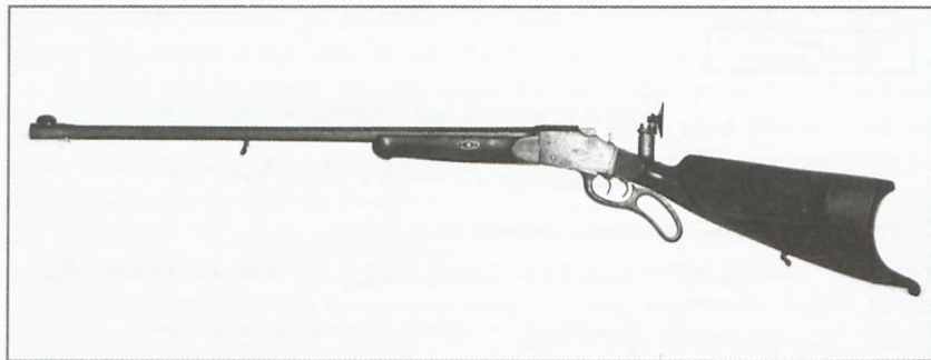
42. Sztucer tarczowy używany od początku XX w. do 1939 r. przez Bractwa Kurkowe do strzelań i konkursów okazjonalnych. Lufa ośmiograniasta kaliber 8,15 mm gwintowana. Długość lufy z komorą nabojeową 75,7 cm. (MS)
