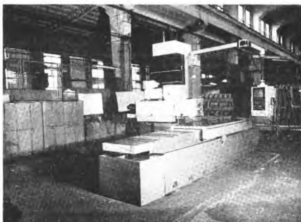
Frezarka łóżowa LUX UBF 2200 wyposażona w układ sterowania numerycznego ciągłego, przeznaczona jest do robót frezarskich części o masie do 5000 kg. Ma szczególne zastosowanie w narzędziowniach przy produkcji matryc, form i wykrojników.
